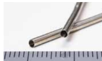
製品名 平板密着ばね 材質 SUS304WPB サイズ 線径0.1mm×0.2mm 等 用途 ガイドワイヤー(医療器具)
