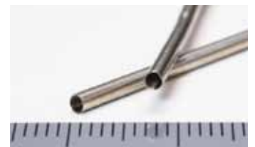
製品名 平板密着ばね 材質 SUS304WPB サイズ 線径0.1mm×0.2mm 等 用途 ガイドワイヤー(医療器具)
