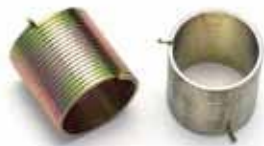
製品名 角線クラッチばね 材質 SWP サイズ 線径1.4mm角 用途 クラッチ
