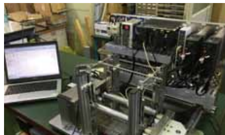
【電位測定器2】 半導体製品の電位測定する測定器。
