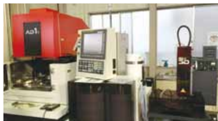
【機械加工設備】例2 高速ワイヤカット放電加工機(AD-1i) 超高速・細穴放電加工機(SH-3D)
