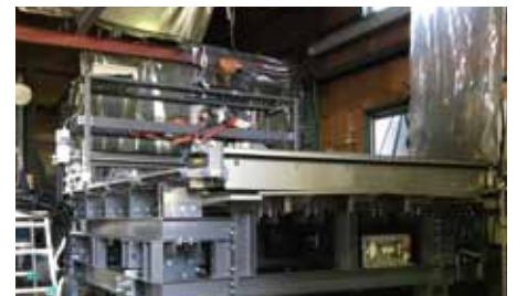
【金属ローラー用平板研磨機】 幅2500までの鏡面研磨機。
