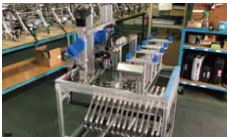
【組立用治具】 どの担当者でも効率的に作業ができる為に組立治具を製作(社内設計)。
