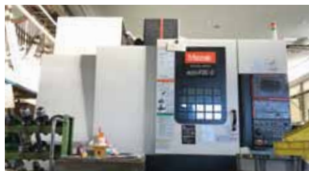
【機械加工設備】例1 マシニングセンター(山崎マザック) X=1050,y=510,z=560
