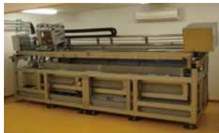
【金属ローラー用ターニングロール研磨機1】 φ300、L2500の円筒シートを鏡面加工する専用機。
