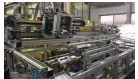
【金属ローラー用ターニングロール研磨機2】 鏡面研磨の主軸部、研磨圧のトルク管理はロードセルに管理。
